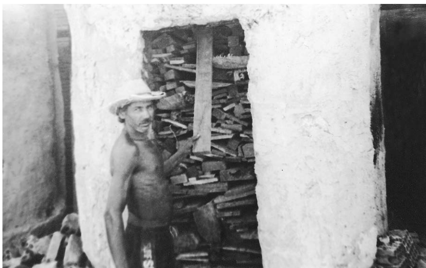
Foto 19: Fornos da “central de carbonização ecológica”: utilizando resíduos de serraria e não coco babaçu, como se propagandeia.
