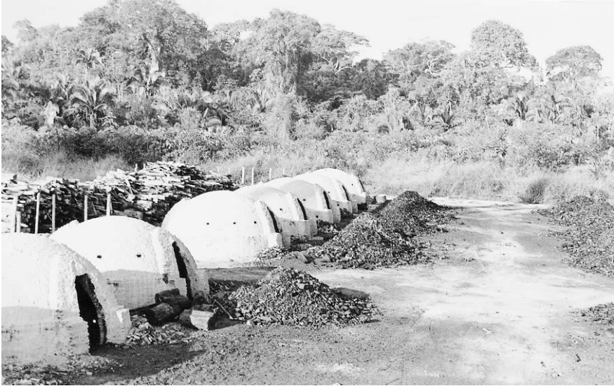
Foto 16: Bateria de fornos tipo japonês onde se carboniza lenha originária de desmatamentos.
